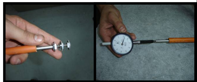
Figura 8 Tell tales a) anclaje mecánico b) Funda, varilla lisa y deformímetro análogo
