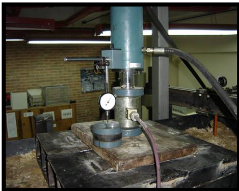
Figura 7 Detalle de la celda de carga, del deformímetro testigo del desplazamiento y de los perfiles de aplicación de carga
