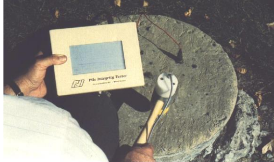
Figura 2 Prueba de Integridad del Pilote (PIT)
